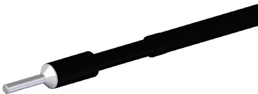
Рис. 13: Установка термоусадочной трубки
