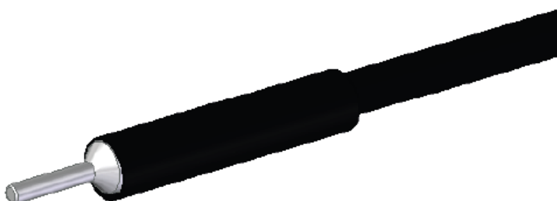
Рис. 12: Установка термоусадочной трубки
